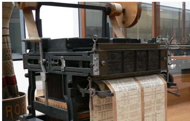
Figura 4: Máquina de Tear de Jacquard
